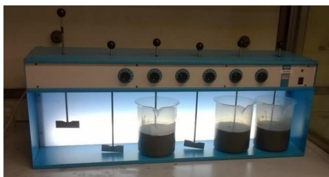
Figura 14: Dispositivo de prueba de jarra utilizado para acondicionar las muestras de lodo
