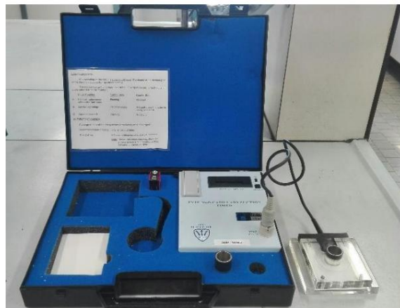
Figura 13: Dispositivo de tiempo de succión capilar utilizado en el laboratorio.
