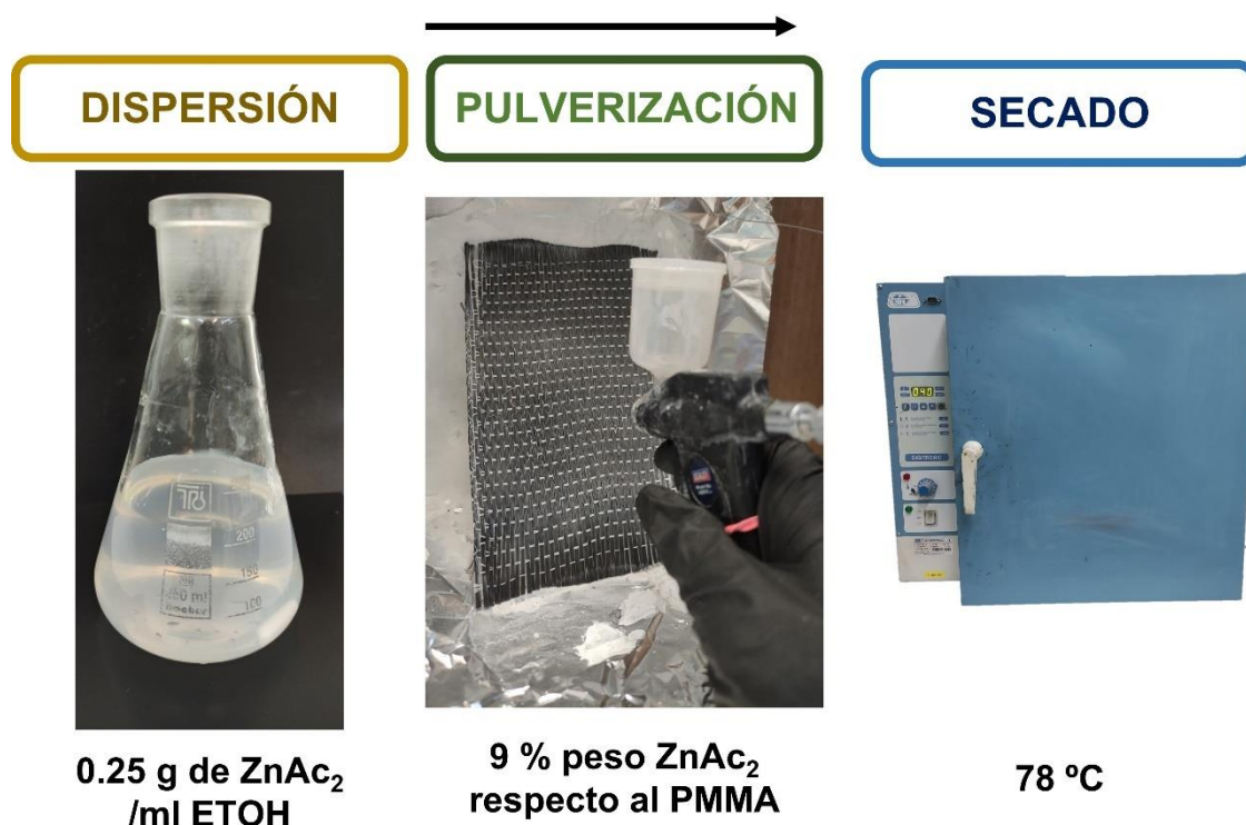
Figura 3.5 Incorporación del catalizador sobre la superficie de las fibras.
